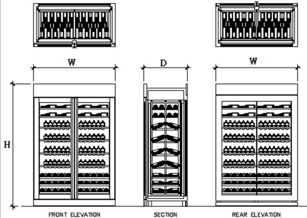
1. ケース外側、内側、正面は鏡面 SUS 304 1.2mm 厚さのステンレス板製です。
