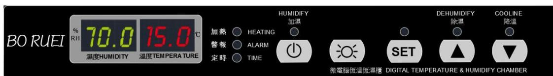
5. コントロールユニット:分離式コントロールユニットで、コンプレッサーは室外に設置する室外機内に付いています。コンプレッサーは国外産 Danfoss 1.5HP を使用しています。高湿度型蒸発器、凝縮器1組が付いています。騒音による室内への影響がありません。内蔵の空冷式完全密閉型コンプレッサーは、環境保護対応冷媒、過負荷保護スイッチを採用しています。特許の自動遮断機能付き無給水型加湿器、温度超過時遮断式ヒーター、自動くもり防止のための熱線を採用しています。除湿排水は電磁弁により自動的に貯水盤に排出され、放熱排管から自然に蒸発します。庫内は空冷式循環方式を採用しています。コンプレッサー及び放熱器は約10m離れた室外に移動して騒音及び熱源を避けることが可能です。ワインセラー本体の下に排水口を設ける必要があります。
